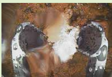
2号機での堆積物接触調査
